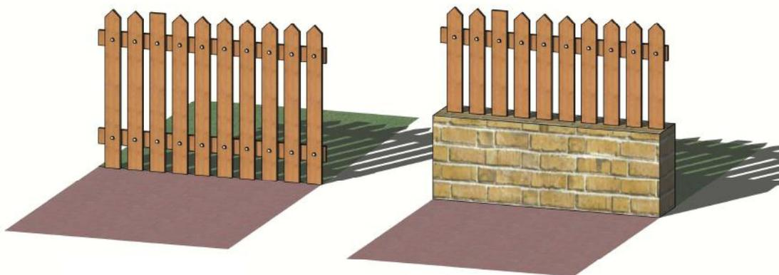
**Abbildungen:** *Schema über Staketenzäune*
